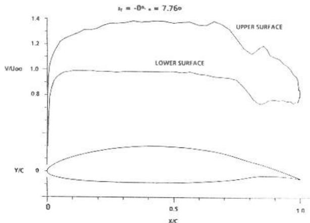
FIGURE 2.-VELOCITY DISTRIBUTION FOR WORTMANN FX 79-K-144/17 AIRFOIL.
