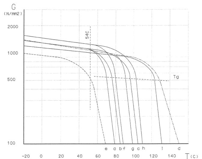
kuva C8 Eri epoksihartsien liukumoduli  $G$  lämpötilan funktiona
